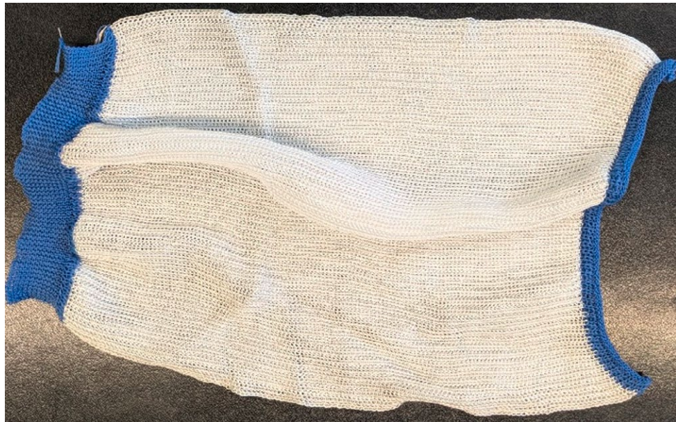
Abb. 18: Gestrick aus Glucanfasern eingefasst mit blauem (nicht biobasiertem) Polyester.
